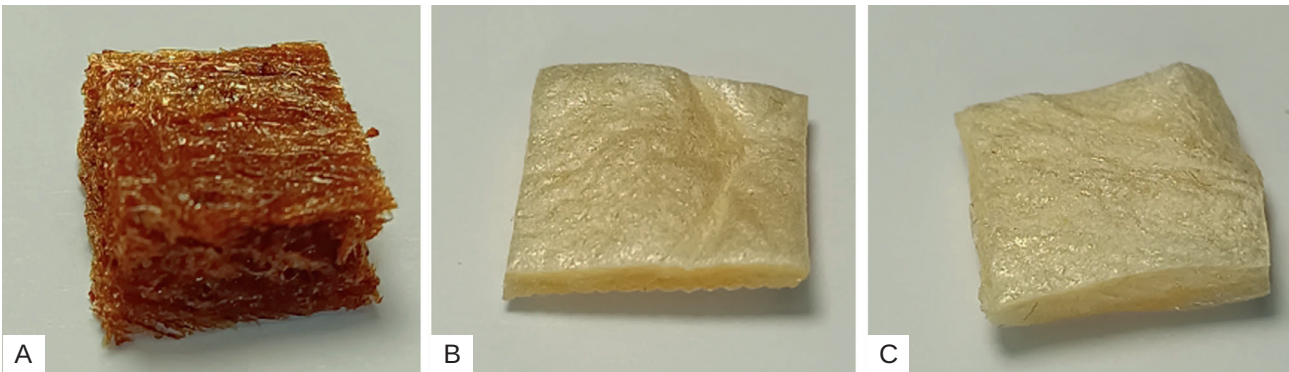
Рис. 1. Внешний вид губок из аскорбата (А), гликолата (В) и лактата (С) хитозана размером 1х1 см 2 Fig. 1. Appearance of sponges made of ascorbate (A), glycolate (B) and lactate (C) chitosan size 1x1 cm 2
